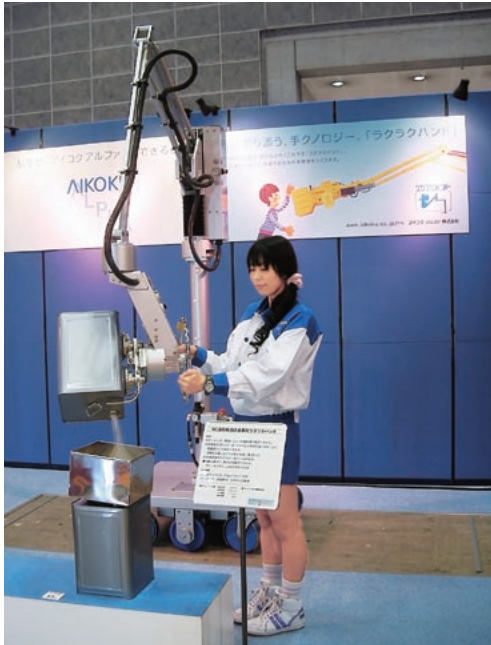
定格荷重 38 kg ワーク重量 max 25 kg で展示しています。
