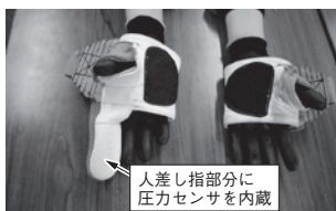
写真8 圧力センサを内蔵したグローブ
