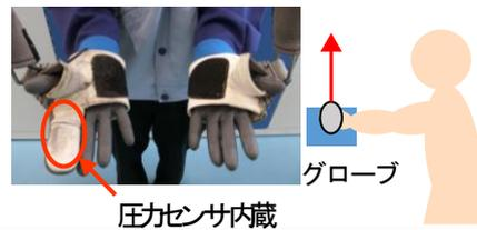
圧力センサ内蔵グローブを装着することで多種多様な荷役物を把持し運搬作業をアシスト。
